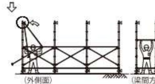
③下段から上段の外側面の先行手すりを設置する。
