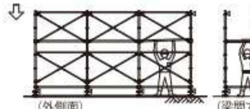
④2段目の鋼製布板を設置する。
