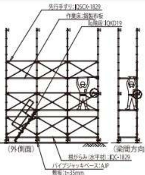
⑦3段目の鋼製布板を設置する。階段等を設置して上段に上がり軸体側面に2段手すり(水平材)を設置する。
