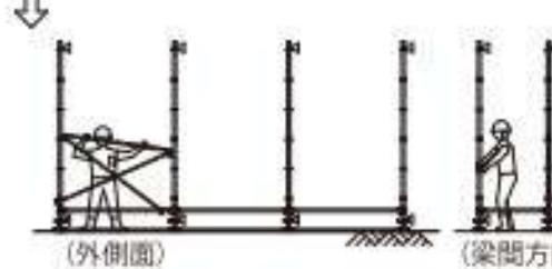
②足場の外側面に先行手すりを設置する。軸体側に根がらみとは別で水平材を1段取付ける。
