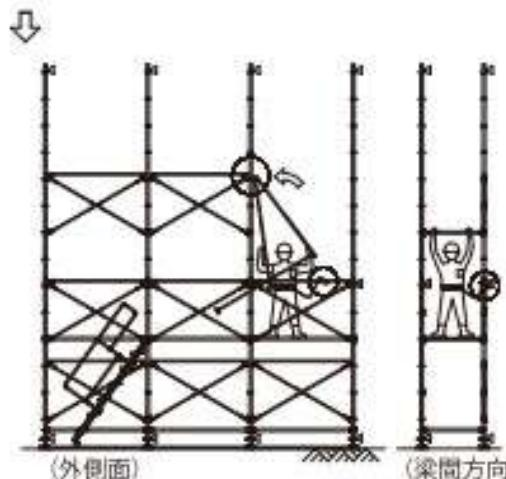
⑥2段目から上階階の外側面に先行手すりを設置する。
