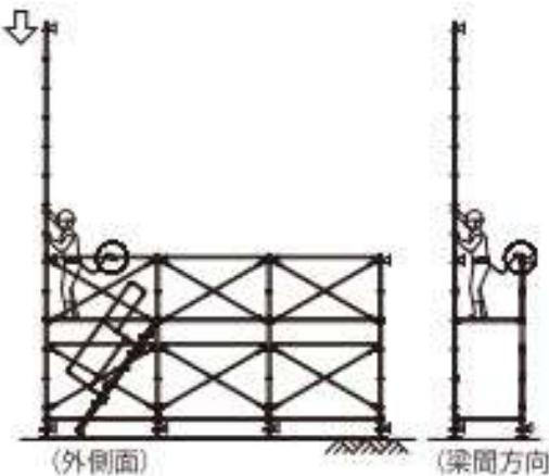
⑤階段等を設置し上段に上がり軸体側面に2段手すり(水平材)を設置する。2段手すりを設置した後2層目の支柱を設置する。(支柱のロックピンを確実にロックする。)(全ての作業は③で設置した先行手すりに安全帯を掛け行う。)
