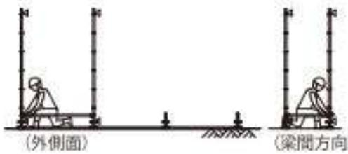
①根がらみを取りながら支柱を設置する。(支柱が倒れないように注意)ジャッキベースを調整しレベルを確認する。
